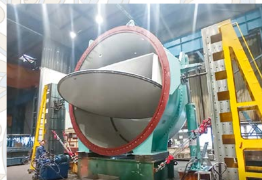
ANDRITZのハンガリー工場でのFAT (工場出荷前試験) 中のPIV
