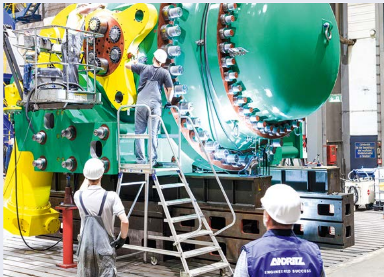
2022年秋、お客様立会いの下行われたDinorwig発電所向け球形バルブの6つのうちの1つ目の耐圧試験と工場出荷前試験
