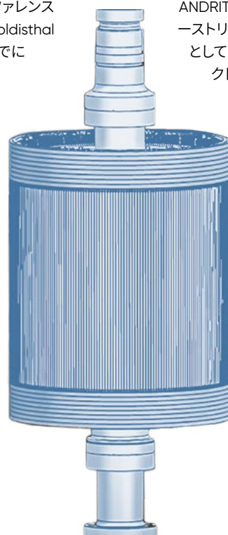
Limberg 3発電所の回転子の3D表示
