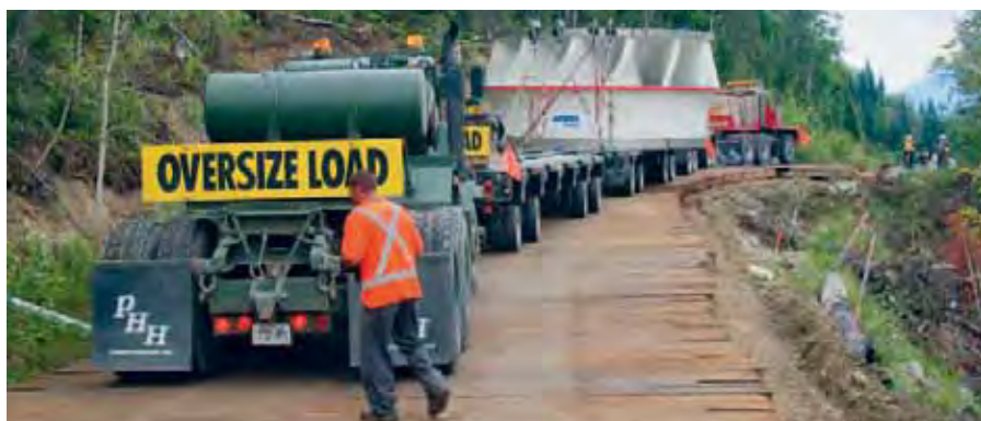
▣ Entrega de rotor de 520 MW para a unidade 5 da UHE de Mica na Colúmbia Britânica.
