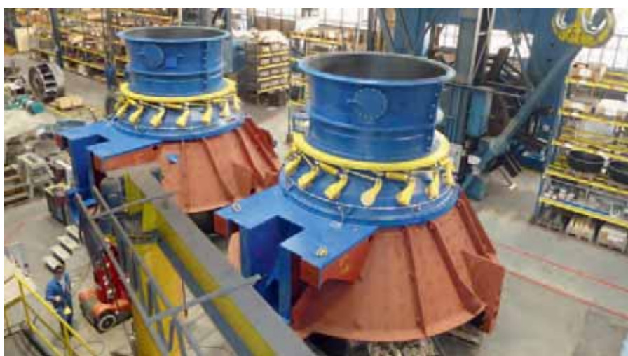
▣ Turbinas axiais do tipo bulbo compactas para a IUHE de Lixhe durante a montagem na fábrica
