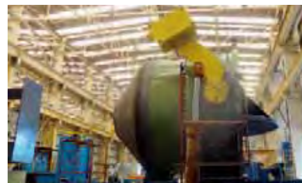
Válvula borboleta montado no centro de produção da ANDRITZ HYDRO no México
